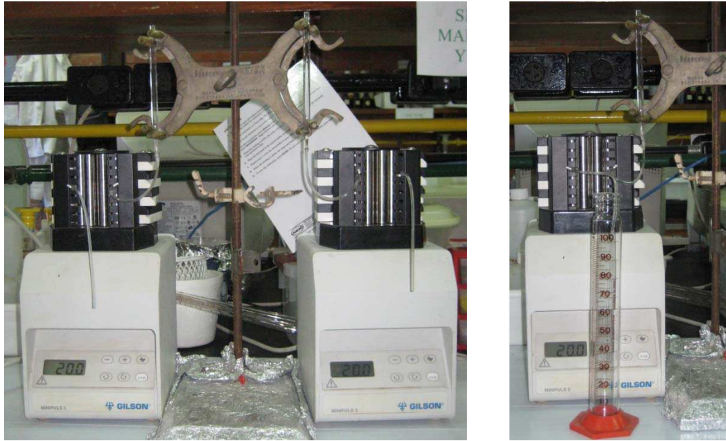
Figura III.3.2: Fotografías del sistema experimental de adsorción de metales pesados por U. lactuca empaquetada en columnas.
