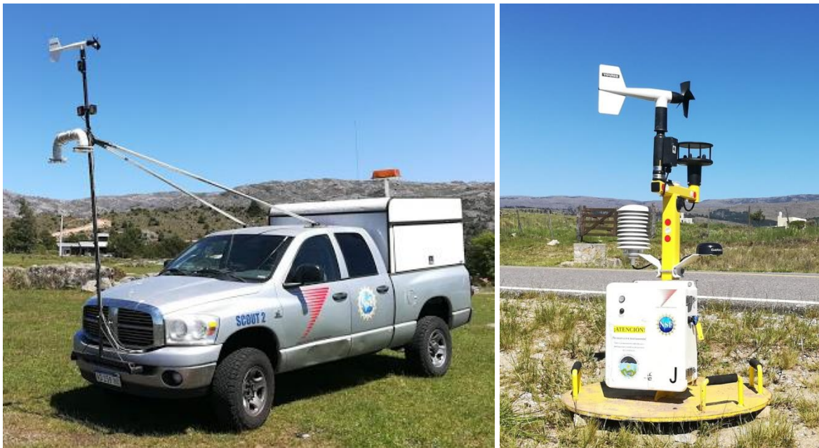
Camioneta MM2/SCOUT2 (izq.) y estación meteorológica portátil POD (der.) [Foto: Luciano Vidal]
