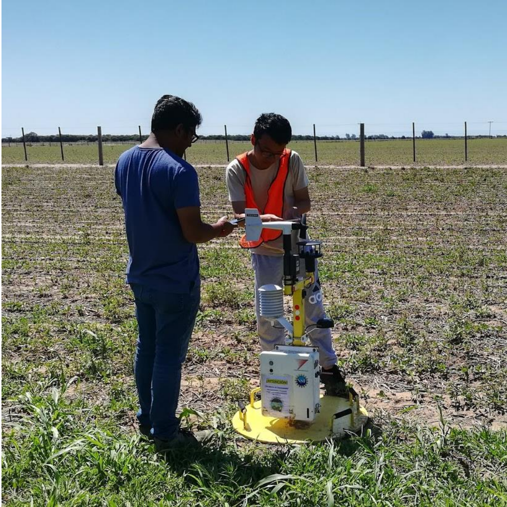
Verificación de la correcta orientación del POD respecto del Norte utilizando un compás magnético [Foto: Luciano Vidal]
