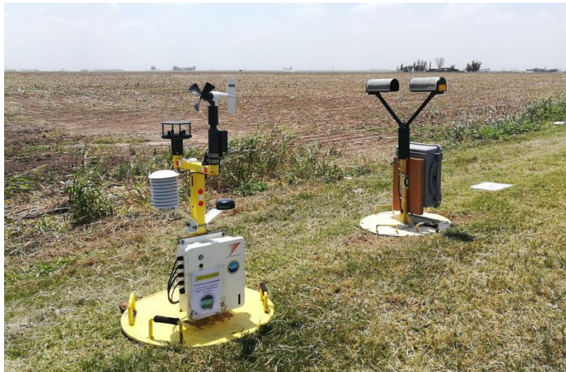
Vista en campo de uno de los disdrómetros (der.) desplegado para medir precipitación junto a un POD (izq.) [Foto: Luciano Vidal]
