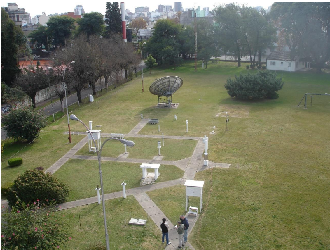
Figura 1: Campo tipo de una estación meteorológica convencional, en este caso Observatorio Buenos Aires, Argentina. Observar dimensiones del predio, perímetro, personal e instalaciones.
