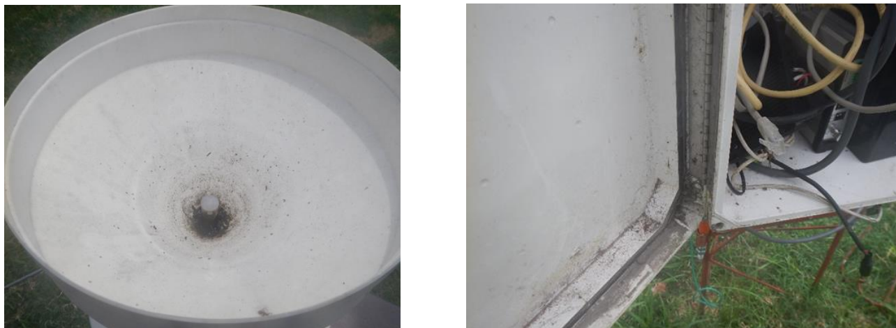
Figura 3: Deposición de polvo sobre sensor de precipitación y gabinete.
