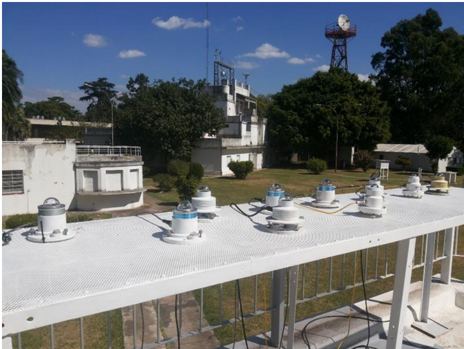
Fig. 4. Radiómetros UV instalados en el banco de calibración a fin de asegurar que la irradiancia recibida sea la misma.
