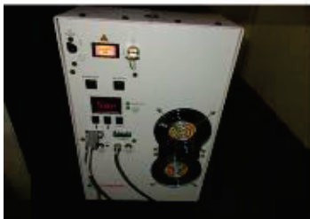
La fuente del láser (parte frontal y parte trasera) y su refrigerante
