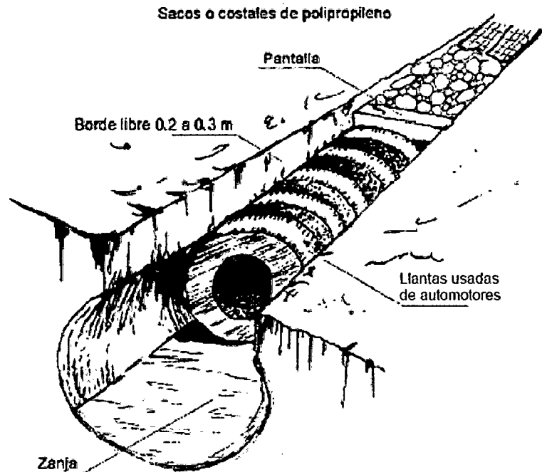
Figura 35. Zanja de lixiviado para recibir las llantas usadas
