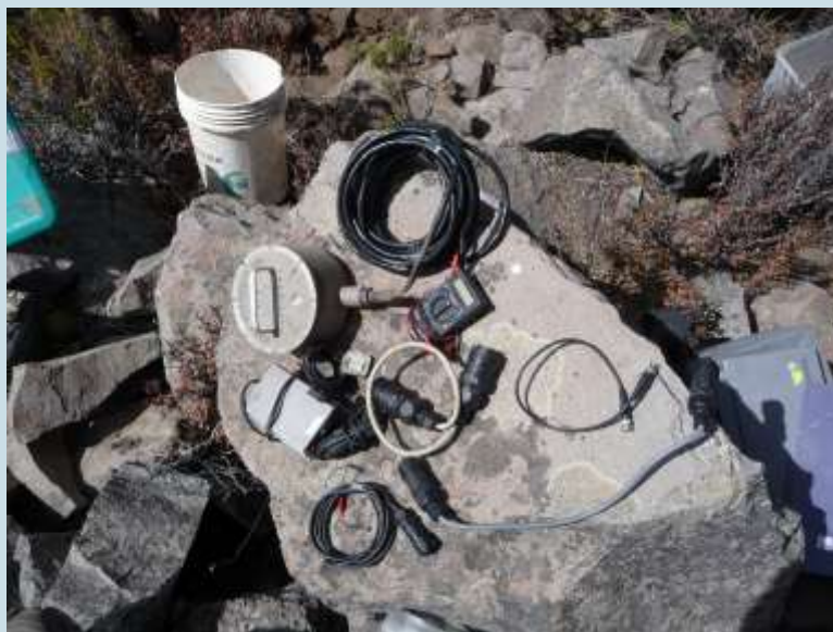
Foto N° 5. Sensor sísmico Marc Products, cables y conectores de la estación Titan.
