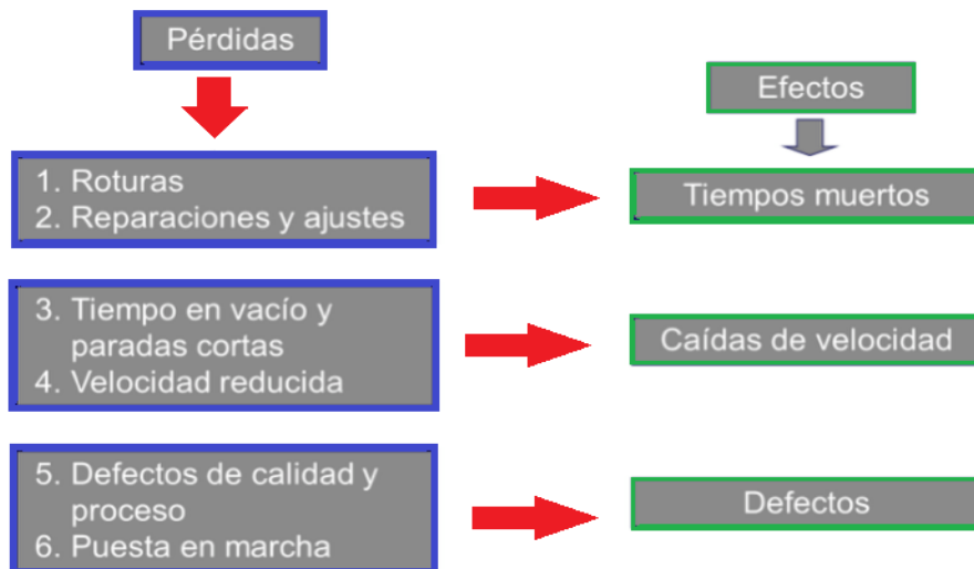
Figura N ° 7 Agrupación de las pérdidas en función de los efectos que provocan.
