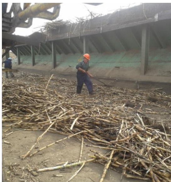
Figura N ° 18 Pérdida de materia por maltrato de camiones
