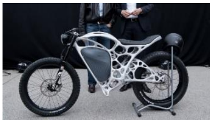
Fig. 5 Chasis de motocicleta, Airbus 3DPrint popularmechanics.com
