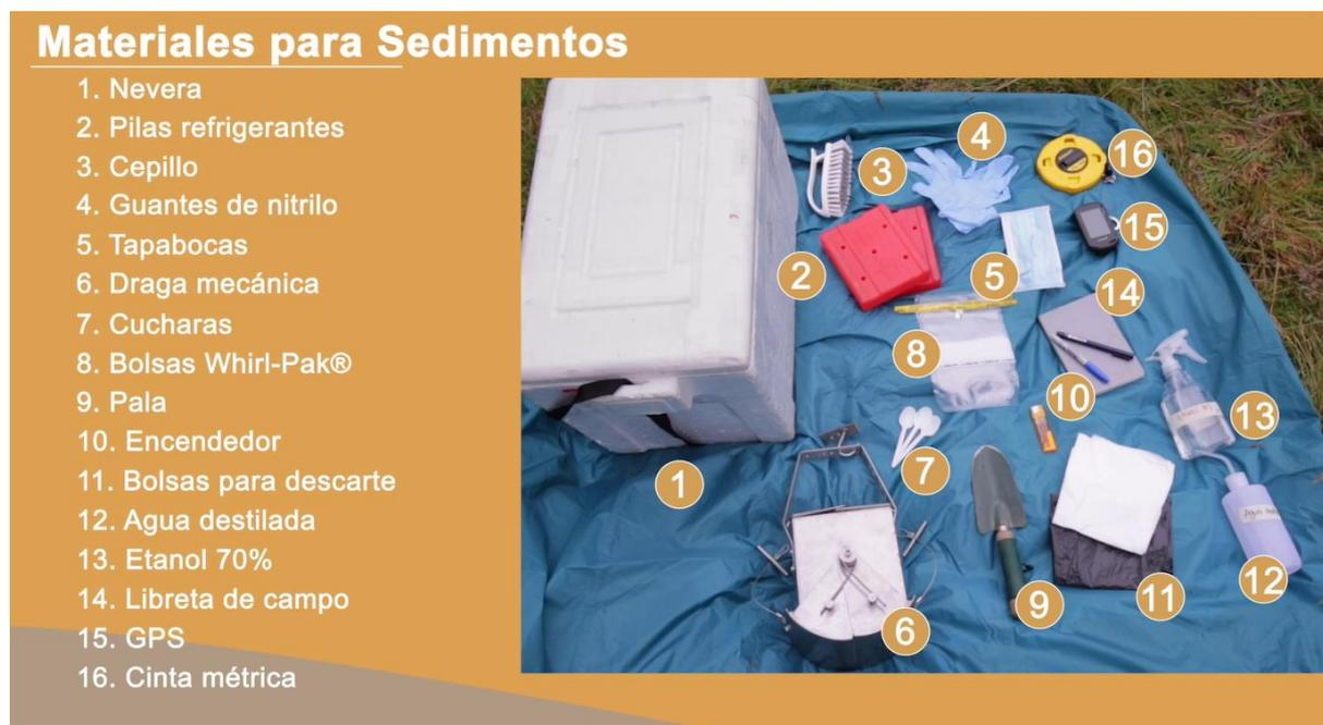
**Figura 6.** Listado de materiales para toma de muestras de sedimento superficial. La selección entre el uso de una draga (6) o una pala (9) dependerá del cuerpo de agua.
