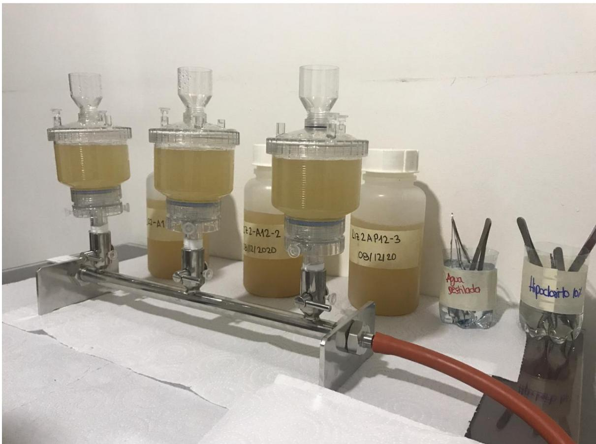
**Figura 5.** Ejemplo de sistema de filtración por bomba de vacío. Fotografía de Paola Pulido-Santacruz - IAVH
