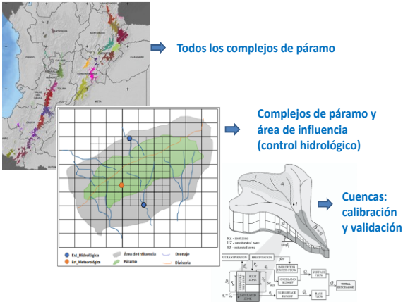
Figura 13. Unidades de análisis y escalamiento del monitoreo hidrológico en los páramos
