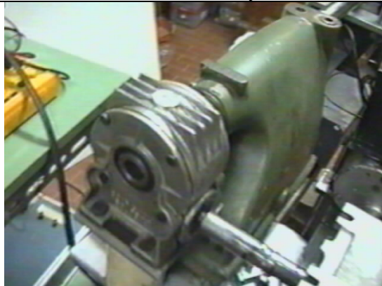
Foto 7: Reductor y convertidor
