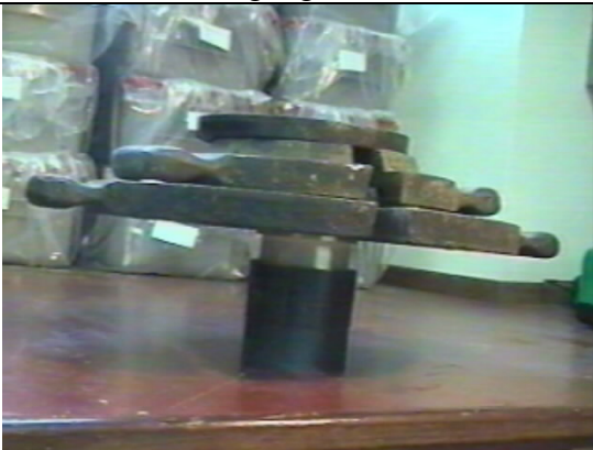
Foto 27: Aplicación de la tensión normal inicial de 50 kPa
