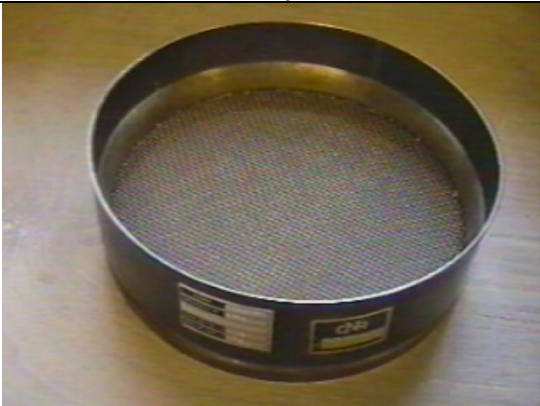
Foto 19: Tamiz con malla de 2 mm
