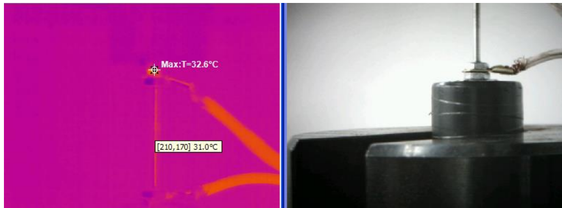
Figura 3-18 Temperaturas externas de las probetas ensayadas a tracción asistida con electropulsos; Montilla et al (2017)
