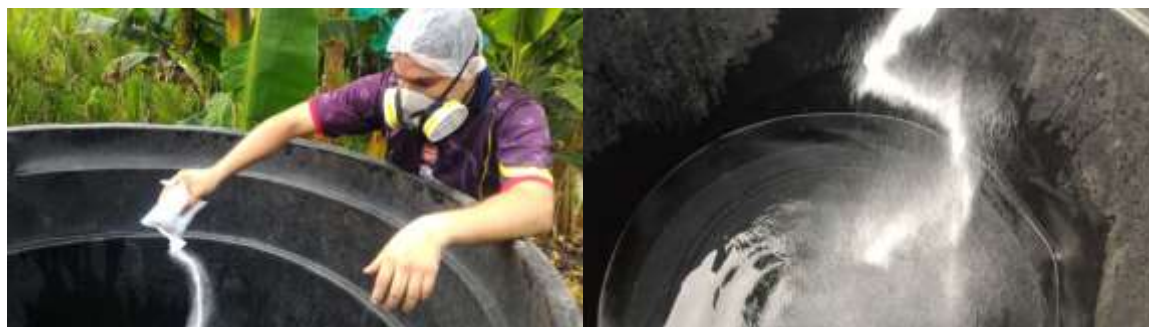
Figura 11. Proceso de preparación de la solución de metabisulfito de sodio y ácido cítrico.
