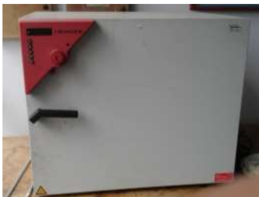
Figura 6. Estufa utilizada para el proceso de obtención de las curvas de secado de la cáscara de plátano.
