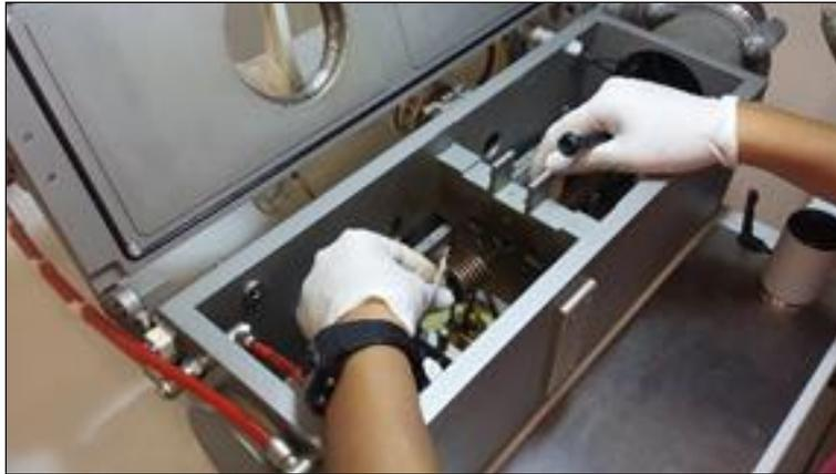
**Figura 19.**Dilatómetro marca DIL805A/D (PMT/USP)
