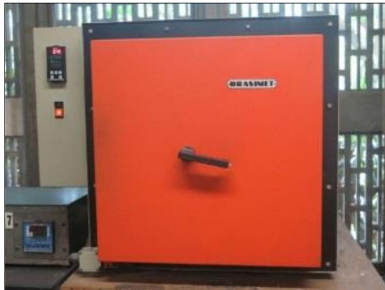
**Figura 21.** Horno tipo mufla utilizado en los tratamientos térmicos (Laboratorio de Transformaciones de Fase perteneciente al PMT/USP - Brasil)
