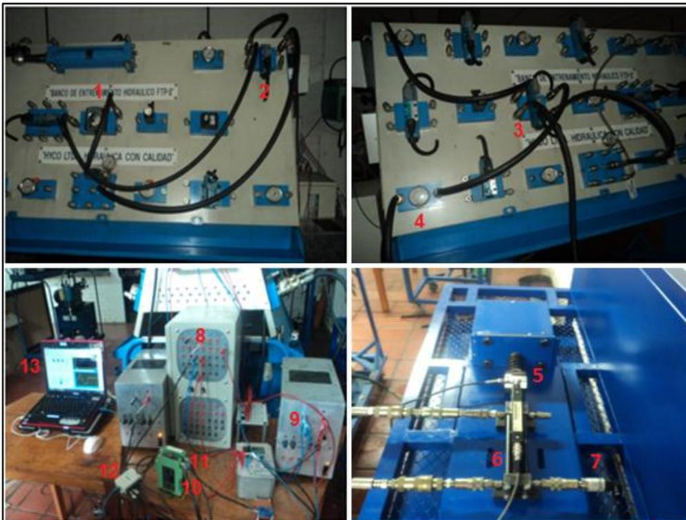
1. Válvula reguladora de caudal compensada por presión y temperatura, 2. Válvula de alivio proporcional, 3. Válvula 4/3 con centro en tándem, 4. Manómetro, 5. Celda de carga, 6. Actuador hidráulico, 7. Transductor de presión, 8. Tarjeta amplificadora EEA-PAM-513-A-32, 9. Fuente DC, 10. Amplificador celda de carga, 11. Tarjeta amplificadora, 12. Tarjeta NI-USB6008, 13. PC
