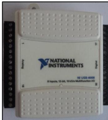
**4.2.4 Amplificador de salida.** Este amplificador es empleado debido a que la salida de la tarjeta de adquisición de datos maneja una corriente muy baja y por ello es necesario emplearlo como medida de protección de la tarjeta NI-USB6008, que se muestra en la figura 43.
