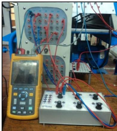
El voltaje suministrado a la tarjeta de amplificación de la válvula, fue incrementado de manera gradual, iniciando desde 0 hasta 10 voltios con intervalos de 0.2 voltios, obteniendo así la mayor cantidad de puntos posibles para visualizar la
