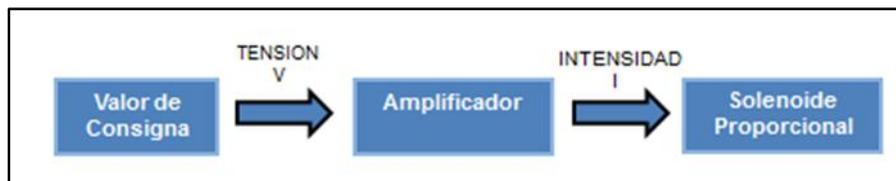
El amplificador cumple la función de corrección, compensa las zonas muertas de la válvula hidráulica, modula el ancho de pulsos para transformar la señal y finalmente brinda la capacidad eléctrica necesaria para el funcionamiento del solenoide proporcional (ver figura 45).
