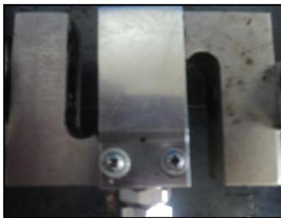
Los patrones fueron puestos de manera individual sobre la celda de carga. La lectura que se registró en el medidor de voltaje se repitió en varias ocasiones, obteniendo el mismo resultado. Inicialmente los patrones se fueron ubicando hasta lograr un registro de voltaje, esto se alcanzó con el patrón de 10kgf; las diferentes combinaciones de los patrones y sus resultados fueron registrados en el cuadro 1.
