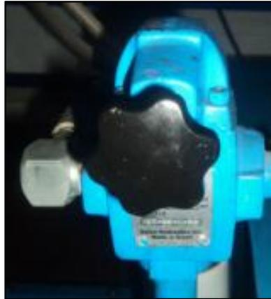
La calibración de la presión de la válvula es determinada por la posición del tornillo de ajuste que varía la presión de acuerdo a la compresión del resorte de mayor tamaño. El pistón se mantiene en su posición equilibrado contra su asiento por la acción del resorte de menor tamaño.
