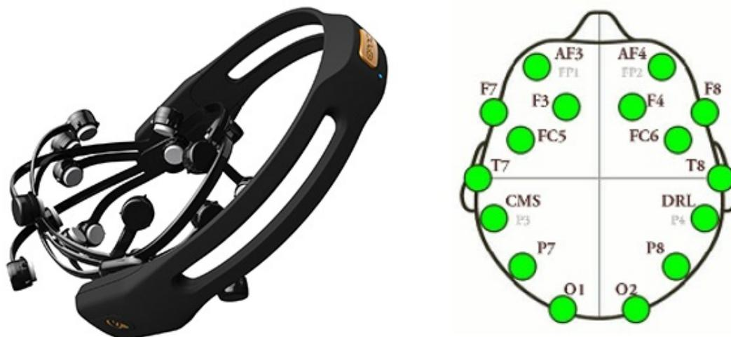
Figura 3.7. Izquierda: Neurocasco Emotiv Epoc. Derecha: electrodos disponibles del sensor según el sistema internacional 10-20.
