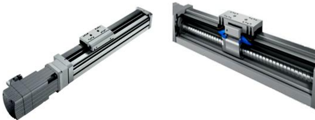
Figura 41. Actuador con husillo sin fin y guías de bolas circulantes
