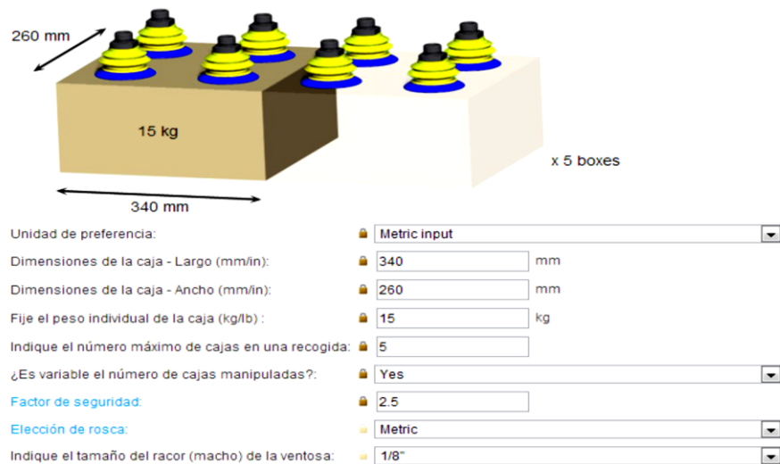
Figura 26. Sistema de agarre por medio de ventosas
