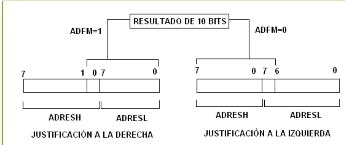
Figura 38. Formato del resultado digital de 10 bits de la conversión.
