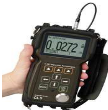
Figura 25 Equipo de comparación CL5 Krautkramer (IRISA)
