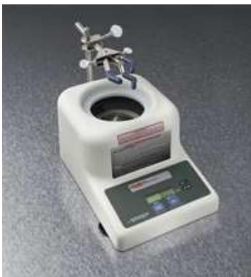
**Figura 34. Vatímetro de Ultrasonido**
