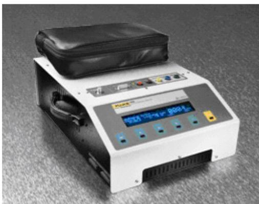
**Figura 33. Analizador de Electrobisturí**
