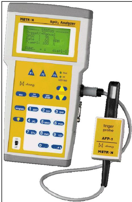
Figura 38. Analizador de Pulsioxímetros SpO2 METRON DAEG
