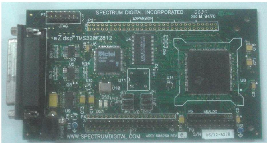
Figura 4.5. Procesador Digital de Señal TMS320F2812.
