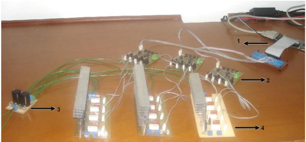
Figura 4.14. Montaje Inversor Trifásico.
