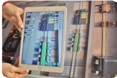
Figura 32. Mantenimiento de planta y máquinas con RA. https://www.neosentec.com/como-la-realidad-aumentada-esta-transformando-la-industria
