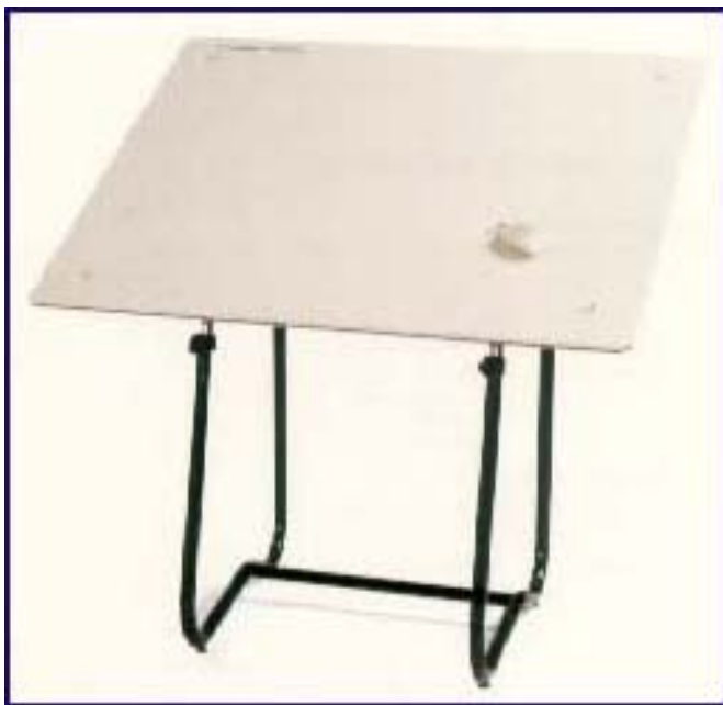
Fig. 2.5. Mesa digitalizadora Summagrid IV, de Summagraphics
