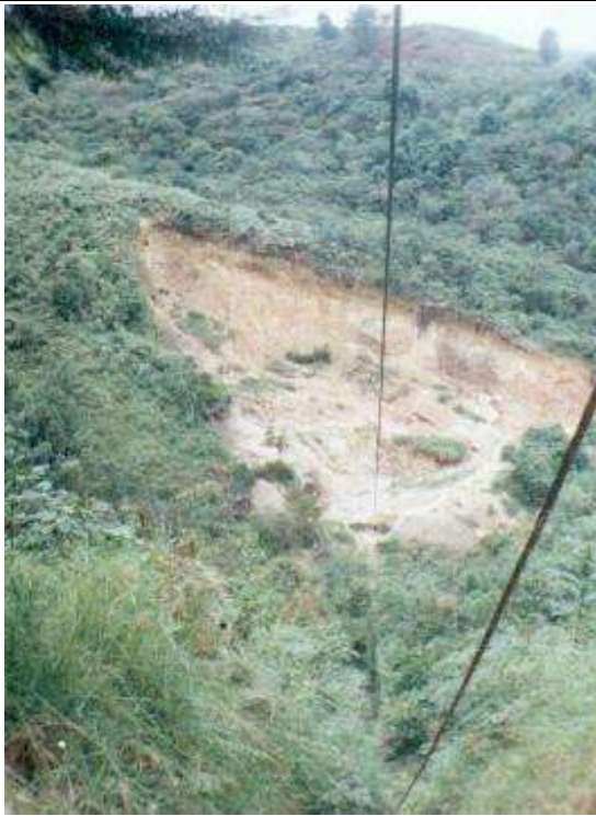
Mina de arcilla en la montaña. La materia prima para la elaboración de ladrillos, se extrae mediante un cajón que se transporta por el aire y es halado mediante un motor que a su vez hala la cuerda.
