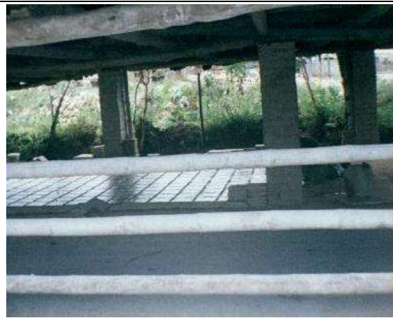
Patio de secado. Se aprecian las unidades frescas en el suelo, donde pasaran entre 30 y 60 días, dependiendo del clima.
