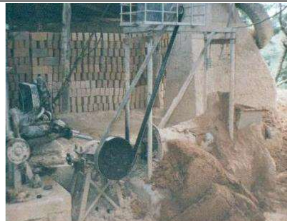
Motor Volkswagen accionando los mecanismos del molino de barro y a la vez los del cajón.
