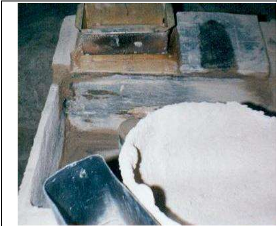
Elementos para el corte de ladrillos. En la parte superior de la foto se aprecia el molde. En la parte inferior se observa un balde donde se moja las manos y la raspa.
