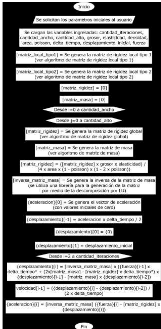
Ilustración 15. Diagrama de flujo funcionamiento general del algoritmo
