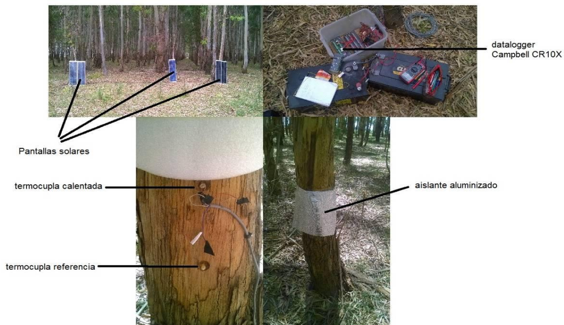
Figura IV.5. Instalación de sensores para la medición del flujo de savia por el método de Granier (p.ej., véase Granier 1985 y 1987).
