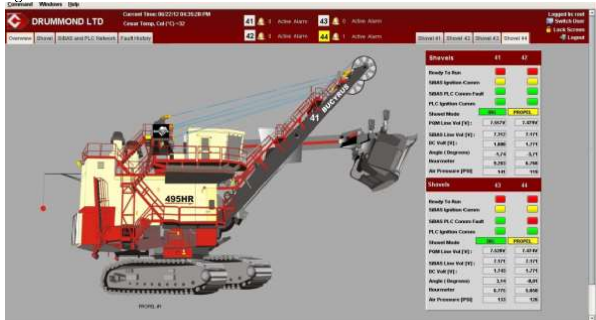
Figura 68. Pantalla inicial del sistema SCADA
