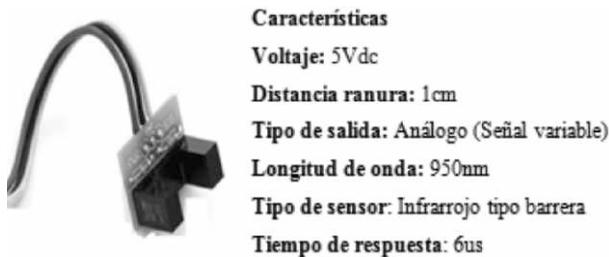
Figura 2. Sensor óptico CNZ1120
