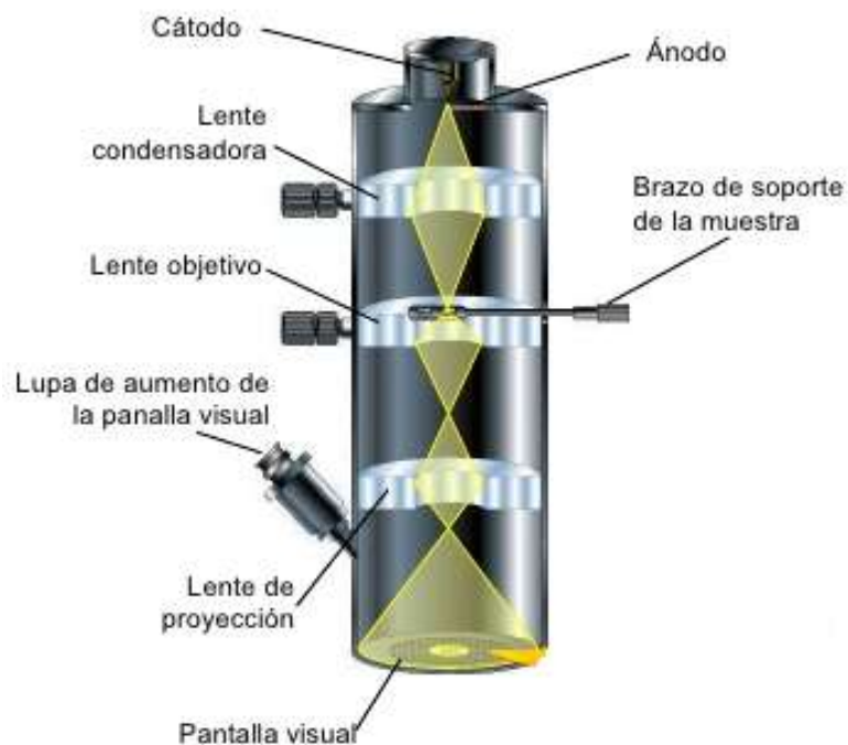
Figura 18. Partes de un microscopio electrónico de transmisión [22].
