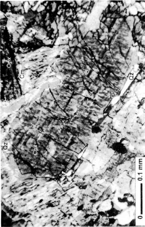
FOTO 7 - Clinopiroxênio (Cpx) exibindo substituição marginal por quartzo (Qtz) simplitético + anfibólio (Act) actinolítico na região de Cachoeira do Mato (Ponto JC-43). Na parte superior da foto, o ortopiroxênio (Opx) é corado por hornblenda (Hb) ou está substituído por interrescamento simplitético de quartzo (Qtz) arredondado + actinolita (Act) azul-esverdeada + cummingtonita (Cm) incolor (Objetiva 6.3x, nx).
