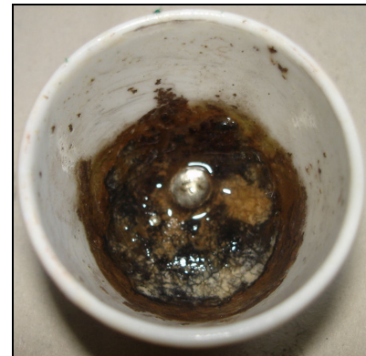
Figura 3. Fotografía del recubrimiento adherido a los crisoles de las probetas
