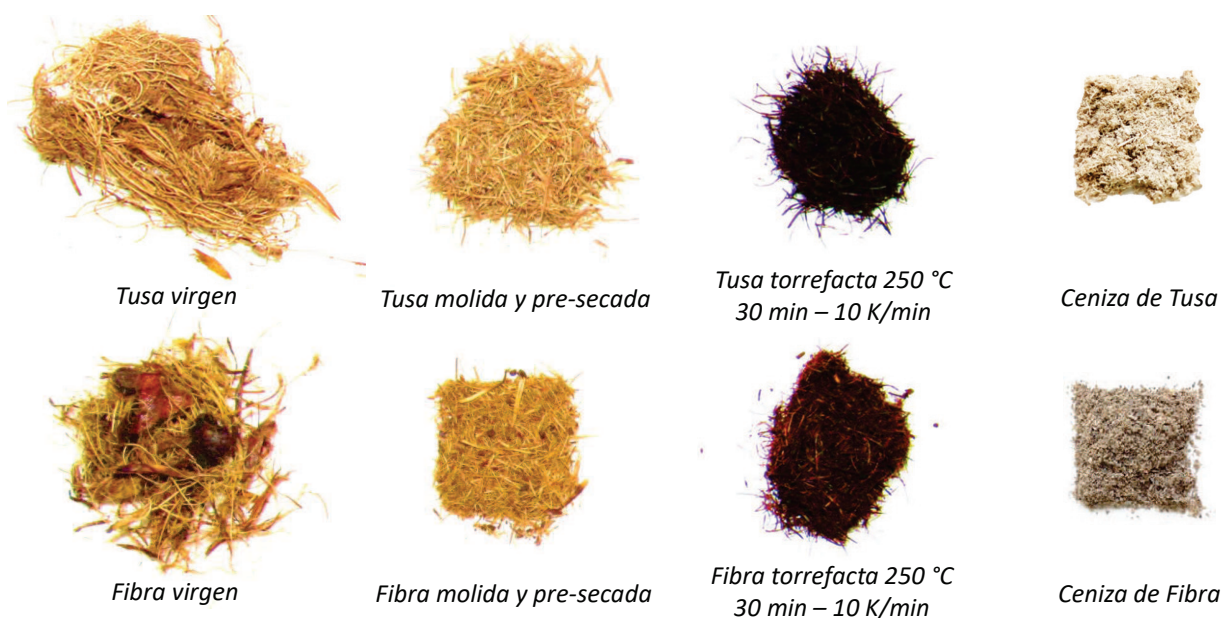
Figura 5-1. Aspecto general de tusa y fibra utilizados en la experimentación durante las etapas: virgen (como se recibe); seca y molida (previo a la torrefacción); posterior a la torrefacción en termobalanza (250 °C durante 30 minutos y 10 K/min); y ceniza.
