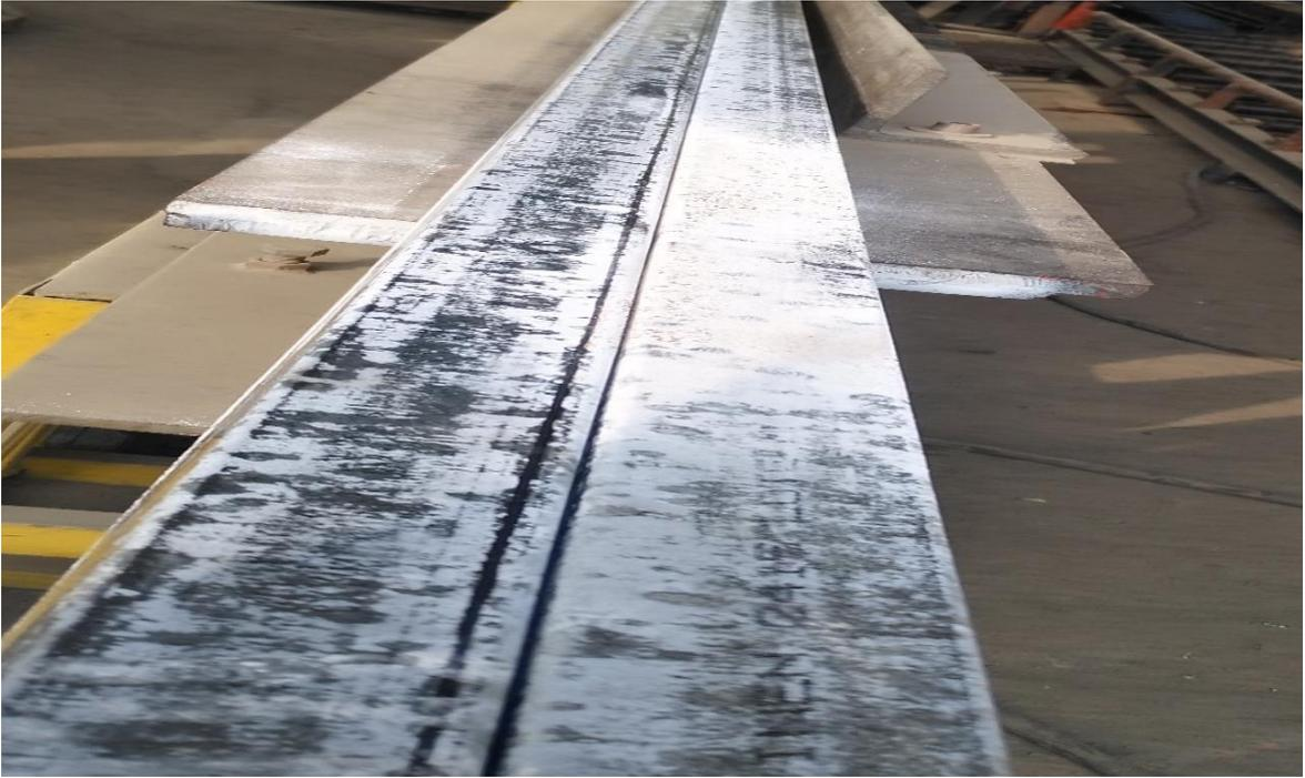
**Figura 5.** Producto galvanizado con oxidación
