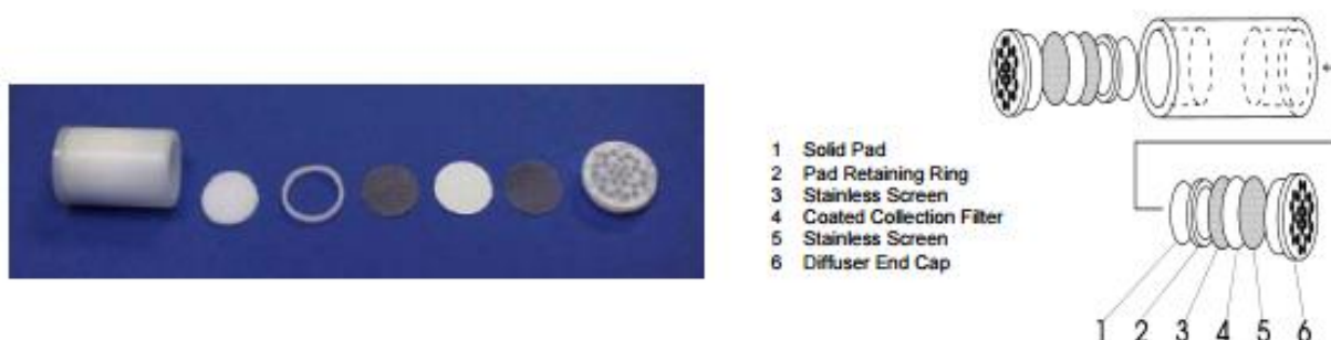
Partes del captador pasivo Ogawa (19)
