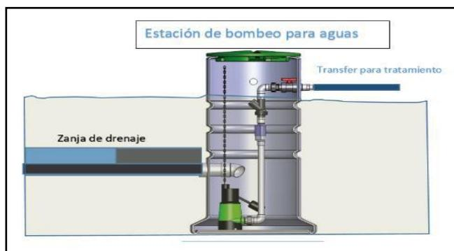
FIGURA 16: Estación de bombeo de aguas residuales
