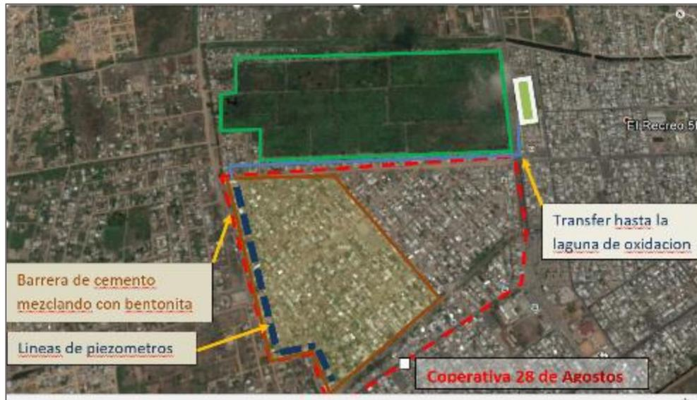
FIGURA 17: Límite de la barrera y línea de piezómetros
