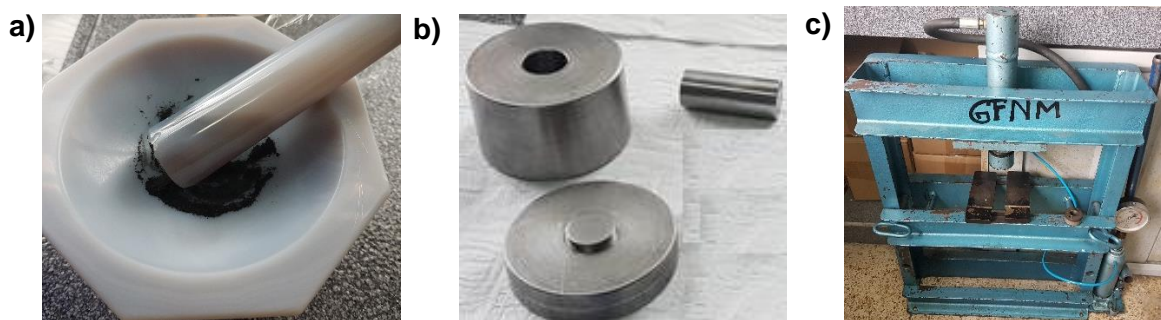
Figura 4-2. Materiales e instrumentos utilizados en la etapa de maceración y compactación. a) Mortero de ágata, b) Matriz y c) Prensa Hidráulica.
