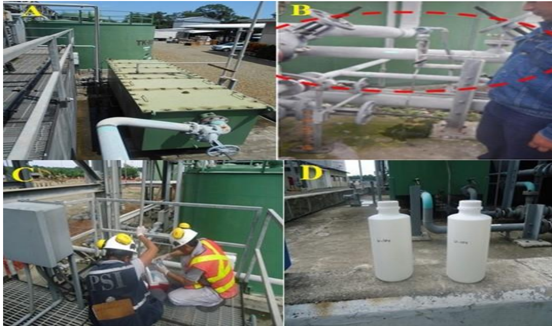
Figura 16. A) Sistemas: PTAR y API hacia TK-109 B) Puntos de toma de muestras C) Toma de muestras en la PTAR y D) Envases rotulados para muestras del punto M3, U-104 RO. Fuente: (Efficacitas Consultora Cía. Ltda., 2015)
