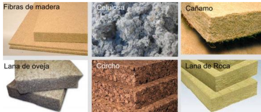
Figura 9. Materiales que ayudan al aislamiento acústico. Fuente: Ecoplaster
