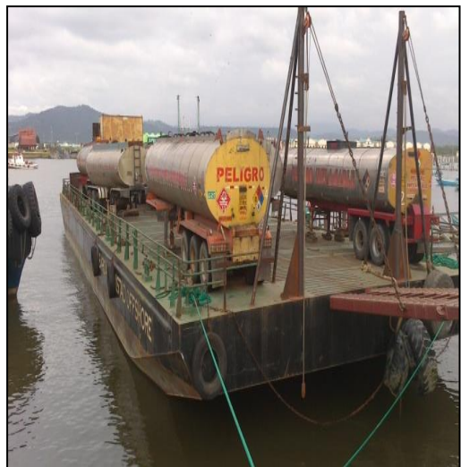
Barcaza que transporta auto tanques con asfalto
