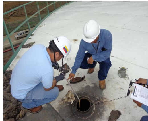
Verificación de la medida de aforo con cinta Lectura del corte en la cinta.
