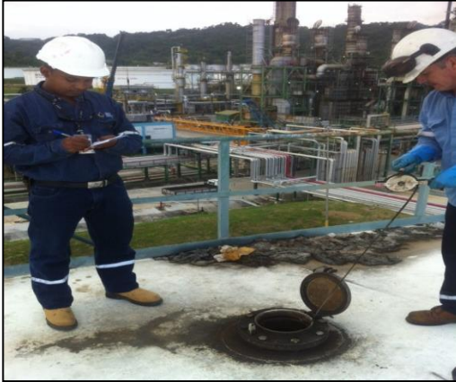
Se fiscaliza el aforo de un tanque (REE) Puesta de pasta indicadora para corte de productos
