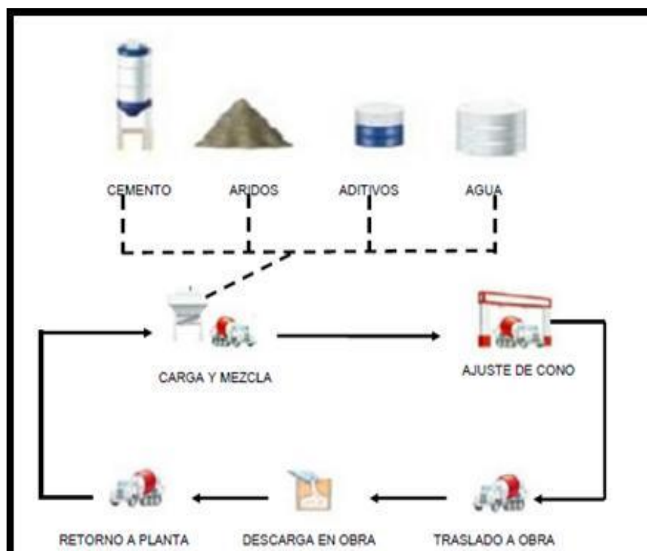
GRÁFICO N° 4 FLUJO DE PROCESO PLANTA DE HORMIGONES
