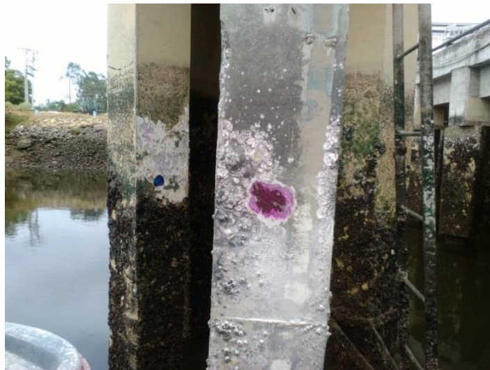
Foto 20: Reacción positiva a la fenolftaleína en un pilote
