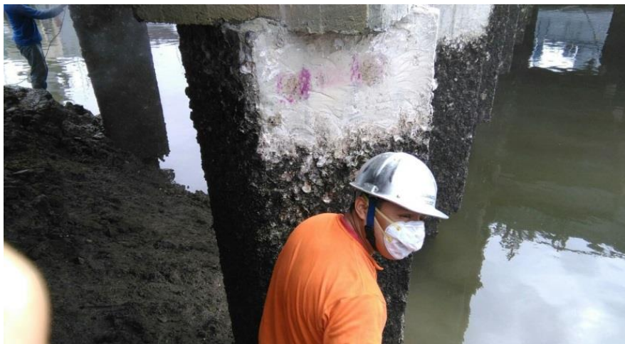
Foto 18: Reacción leve en prueba de Carbonatación con fenolftaleína en pilote. Fuente: Ensayos realizados por INGEOMAT S.A. 15-08-2016
