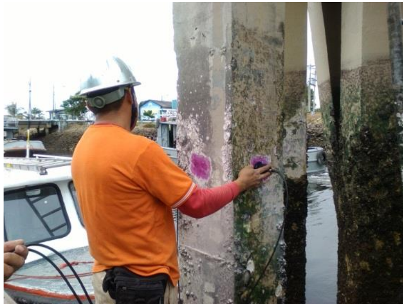
Foto 22: Prueba de Ultrasonido en pilote Fuente: Pruebas y Ensayos realizados por INGEOMAT S.A. 15-08-2016
