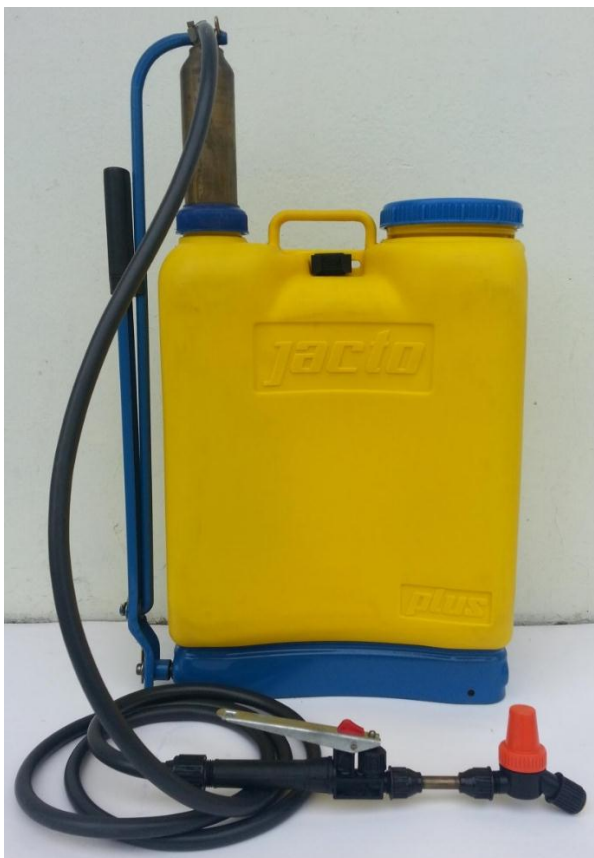
Figura 11. Modelo de la bomba con Válvula de Presión Constante (VPC) Jacto Plus.
