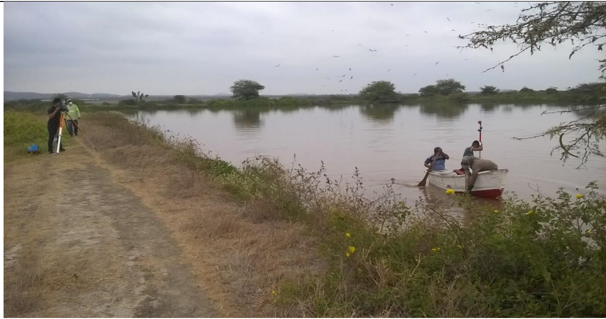
Foto que ilustra el trabajo de batimetría realizado en las lagunas de oxidacion
