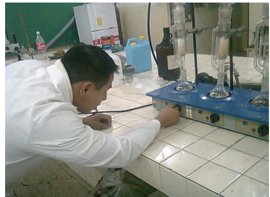
Fotografías 32. Proceso de pesado y destilado del ingrediente activo en el equipo soxhlet ELABORADO POR: Ing. Jaime Maza
