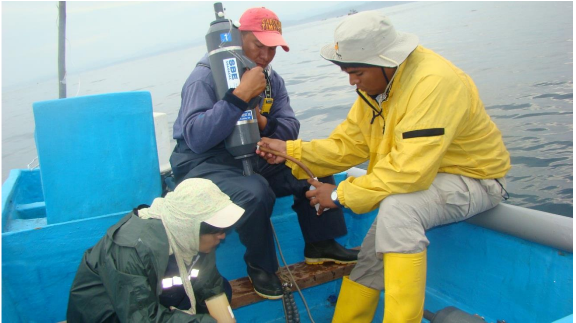
Anexo 3. Obtención de muestras de aguas para fitoplancton, oxígeno disuelto y nutriente por medio de botellas oceanográficas Niskin.
