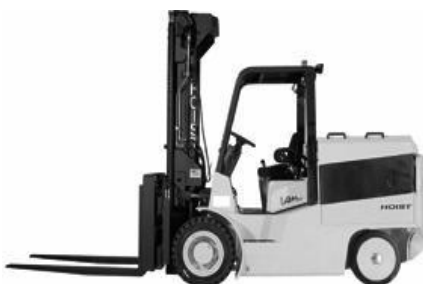
(Fig 2.1.4) Montacargas eléctrico
