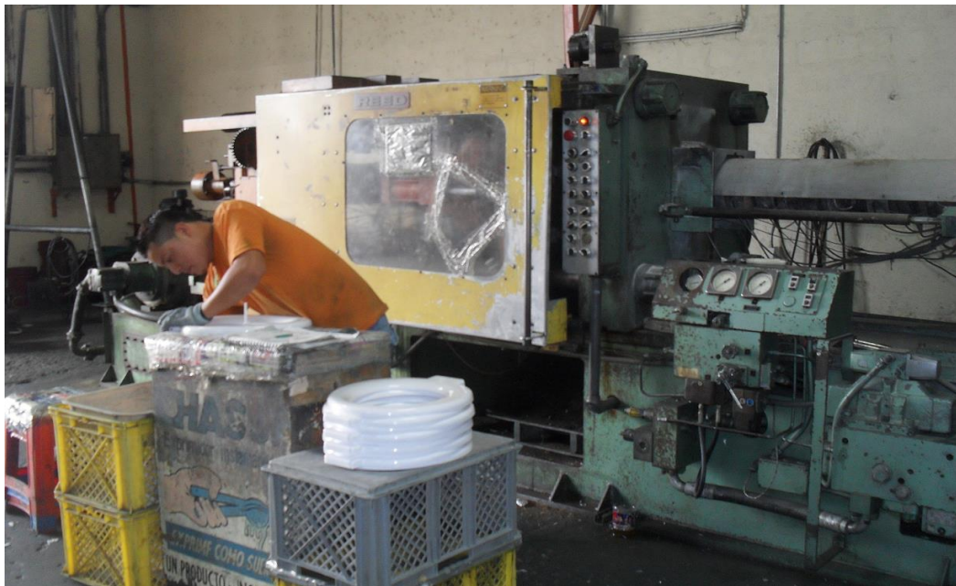
FIGURA No. 6 LABORES EN MÁQUINAS INYECTORAS – RETIRO DE PRODUCTO TERMINADO Y LIMPIEZA DE REBABAS
