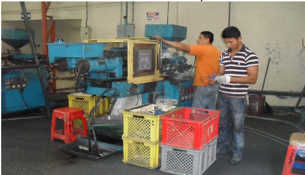
FIGURA No. 17 LABORES EN ÁREAS DE PRODUCCIÓN – CONTROL DE INYECTORA (FALTA DE PROTECCIÓN AUDITIVA EN AMBIENTES DE RUIDO INTOLERABLE)
