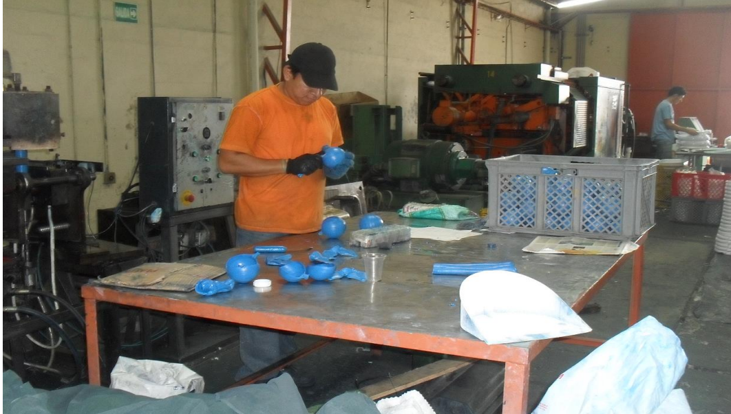
FIGURA No. 16 LABORES EN ÁREAS DE PRODUCCIÓN – LIMPIEZA DE REBABAS (FALTA DE PROTECCIÓN AUDITIVA EN AMBIENTES DE RUIDO INTOLERABLE)
