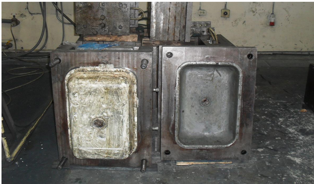
FIGURA No. 8 ÁREA DE MATRICERÍA – MOLDES DE LAVADEROS
