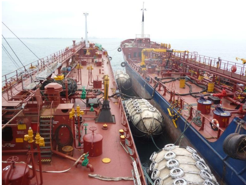
Figura 2.17 Operación de alije, entrega de producto entre buques petroleros, Elaborado por: Paredes Torres Galo Dionicio
