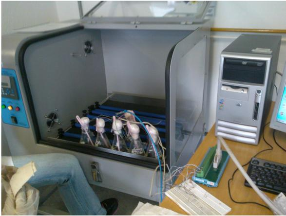
(a) Montaje de celdas en agitador Orbital
